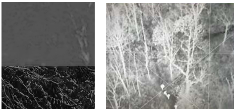
Рис. 1. Плохие текстуры на тепловизионных изображениях в заснеженных районах. Верхняя часть левого изображения тепловое, а нижняя часть обычное изображение с камеры. Тепловизионное изображение справа показывает, что только люди и некоторая часть дерева имеют временную слабую текстуру.
