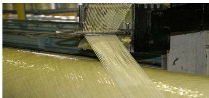
Рис. 1. Метод непрерывной намотки.
