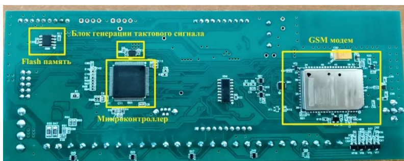
Рис. 3. Нижний слой печатной платы устройства с беспроводным каналом обмена данными
