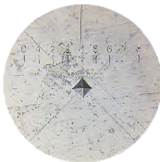
Рис. 1. Образец отпечатка для образца состава 45 мас. % \text{TlBr}_{0,46}\text{I}_{0,54} in \text{AgCl}_{0,25}\text{Br}_{0,75}
