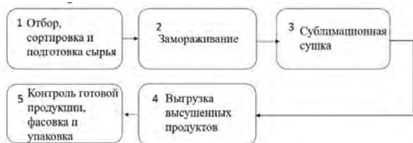
Рис. 1. Технологический процесс производства сублимированной продукции
